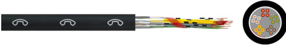
**Verwendung:** Zur Verlegung in Innenräumen, im Freien, in Erde, in Wasser sowie in Beton. Der robuste PE-Mantel ermöglicht eine direkte Erdverlegung. Bei Verlegung in Kabelkanälen und Innenräumen muss berücksichtigt werden, dass der PE-Mantel halogenfrei ist, jedoch nicht flammwidrig nach DIN VDE 0482-332-1.
