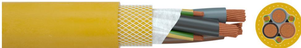
**Verwendung:** Schwere trommelbare Gummileitung für Stromversorgung. In Anwendungen mit hoher mechanischer Beanspruchung, speziell gleichzeitiger Zug- und Torsionsbelastung. Geeignet für motorisierte Kabeltrommeln, Feder-Trommeln und Hubsystemen u.ä.
