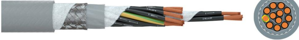
**Verwendung:** Hochflexible Steuerleitung für den ständig bewegten Einsatz unter extremen Bedingungen im Innen- und Außenbereich bei besonderen Anforderungen an die EMV. Die Leitung ist halogenfrei, flammwidrig und beständig gegen die meisten in industrieller Umgebung vorkommenden Chemikalien. Bitte beachten Sie unsere Hinweise für die Verwendung von Schleppkettenleitungen auf unserer Webseite.
