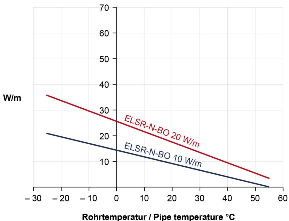
Heizleistung ermittelt an isolierten Rohren bei 230 V unter Nennbedingungen (nach EN 62395-1).
