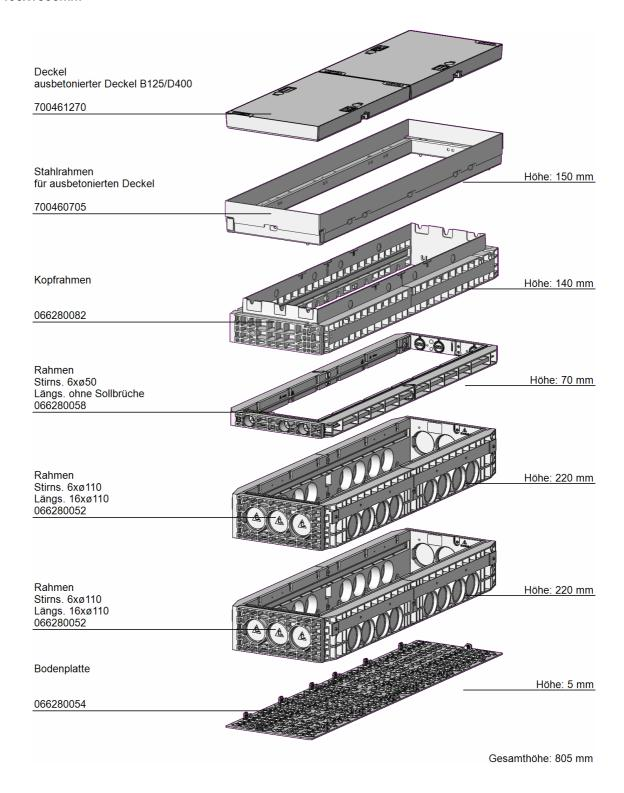
Verriegelung Sechskant SW 24 mit Kundenzeichen mit Höhenausgleich 6 Stufentüllen Gewicht: 375 kg
